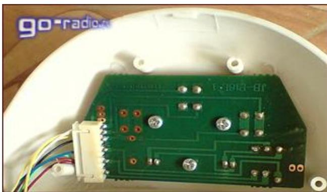
Рис 5. Плата управления и индикации
