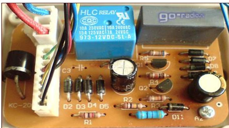
Рис. 4 Основная электронная плата термopота
