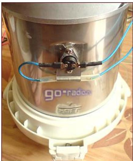
Рис. 8 Защитный термовыключатель
