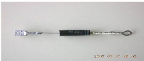
Рис. 3 Высоковольтный диод СВЧ печи
